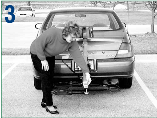
3 Unhook belt and loosen Velcro®*.
